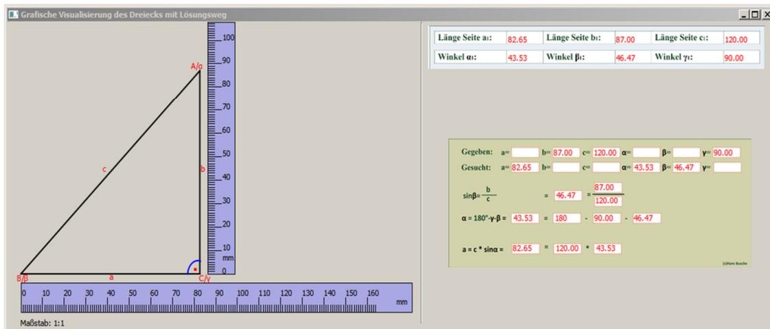
Darstellung eines rechtwinkligen Dreiecks. Selbstverständlich nur eine Lösung. Sinusfunktion als Lösungsweg. Vertikale Lineal folgt der Seite b. Die Lineale haben noch einen Fehler. Die Millimeter-Auflösung stimmt nicht. Irgendetwas habe ich mit den Themen „*Pixel / DPI / Millimeter*“ noch nicht ganz verstanden. Maßstab 1:1.
