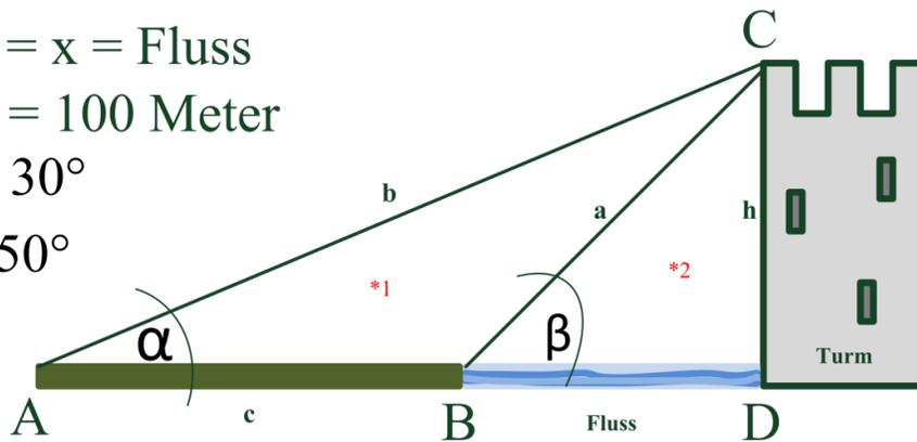
Man erkennt zwei Dreiecke: (\*1) stumpfwinkliges- und (\*2) rechtwinkliges Dreieck. Vom stumpfwinkligen Dreieck können alle drei Winkel berechnet werden. Weiterhin kann mit Hilfe des Sinussatzes die Seite b und mit der Sinusfunktion (für rechtwinklige Dreiecke) die Höhe h berechnet werden. Es folgt ein Ersatzdreieck und die Berechnung:
